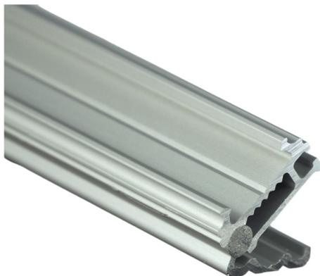
Conçu pour les rubans LED, ce support avec charnière intégrée constitue un excellent dissipateur thermique. Son inclinaison jusqu'à 95° lui permet de s'adapter à toutes les situations de corniches, vitrines ou meubles et d'optimiser le flux lumineux.
